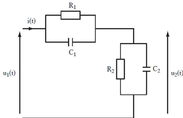
L'impédance  $\underline{Z}_2$  étant imposée, calculer  $R_1$  et  $C_1$  pour que le rapport d'atténuation  $k$  soit constant et inférieur 1.
