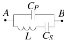
1. Exprimer l'impédance complexe du quartz vue entre les bornes  $A$  et  $B$  et la mettre sous la forme :
